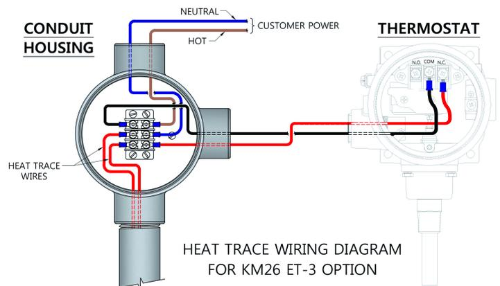
Figure 3.11-2— ET2 & ET3 Wiring
